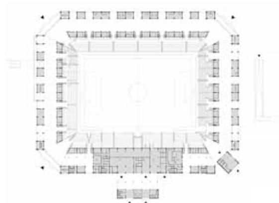
Endzustand acht Segmente ergeben. Um das Gebäude wirtschaftlich und termingerecht auszuführen, wurden hauptsächlich Fertigteile als tragende Bauteile verwendet.
