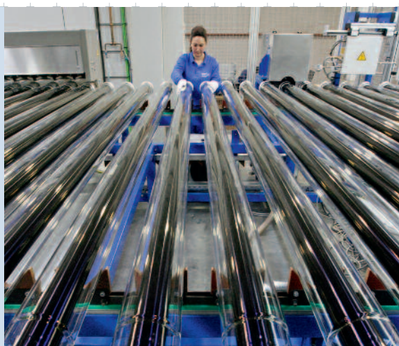
In der Fertigung von Solarreceivern, Schlüsselkomponenten für solarthermische Kraftwerke
